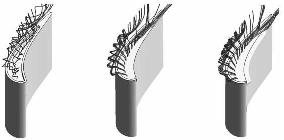
(a) 常规凹槽叶顶 (b) 无压力侧肩壁凹槽叶顶 (c) 带压力侧小翼凹槽叶顶
